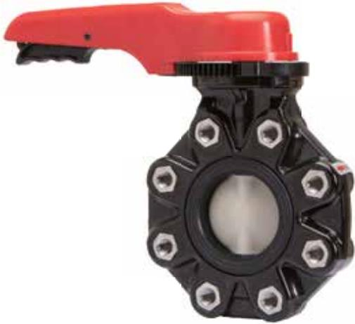
Mit dem Typ 57L wurde eine Lug-Funktion in die Konstruktion der Absperrklappe Typ 57 integriert. Das Lug-Ventil verfügt über Metallgewindeeinsätze an beiden Seiten des Ventilgehäuses und ermöglicht eine einfache und unkomplizierte Wartung an Behältern, Tanks und Rohrsystemen ohne aufwändige Entleerung und bei bestehendem Betriebsdruck. Das Ventil ist ideal für die Wasseraufbereitung und Aquakultur geeignet.
