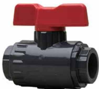
Mit einer geringen Anzahl von Bauteilen, seinem geringen Gewicht und seiner kompakten Bauweise eignet sich der Kompakt-Kugelhahn Typ 27 für den Einbau auf engstem Raum und ist ideal für den Einsatz in Rohrleitungssystemen von Anlagen. Das kugelförmige Ventilelement ermöglicht einen geraden Strömungsweg und erzeugt einen extrem geringen Flüssigkeitswiderstand. Hervorragende Leistung auch bei extremer Wärmeausdehnung und -kontraktion.
